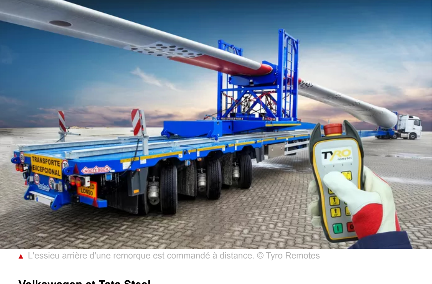
▲ L'essieu arrière d'une remorque est commandé à distance. © Tyro Remotes
